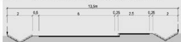
Figur 19 Tverrprofil for kommunal samlevei med fortau
